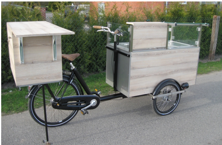
Abb.2.1] Abb:Tupelo 0.2 Fahrrad Länge Aufbau 1200 mm Maultaschenfahrrad
